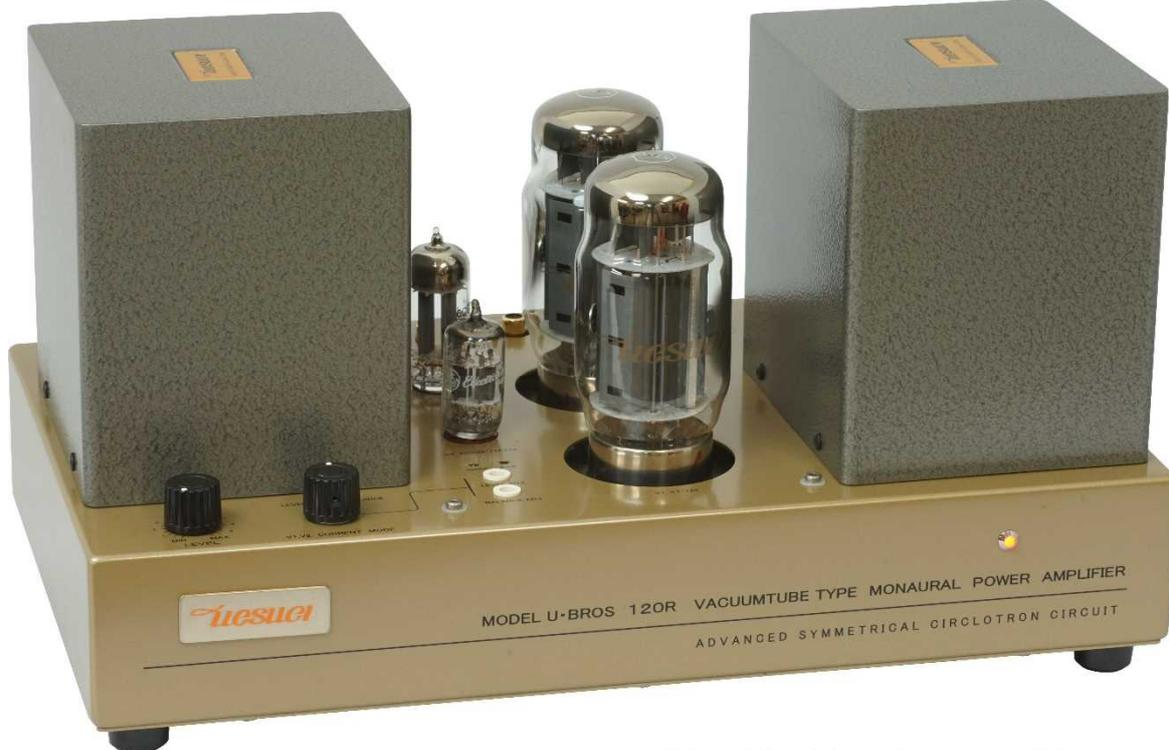
※1950 年代にプッシュプル出力回路の理想を追求し開発されたが、回路規模が大きくなるため商業的拡大に至らなかった。トランス外部でプッシュプルの波形合成がおこなわれる特有の動作原理は現代オーディオにおいてプッシュプルアンプの限界を打破する可能性を有します。
